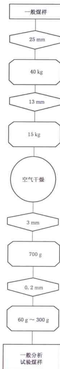
图 10 一般分析试验煤样制备程序示例
